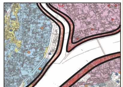
家屋倒壊危険区域 氾濫水により家屋倒壊のおそれがある区域
